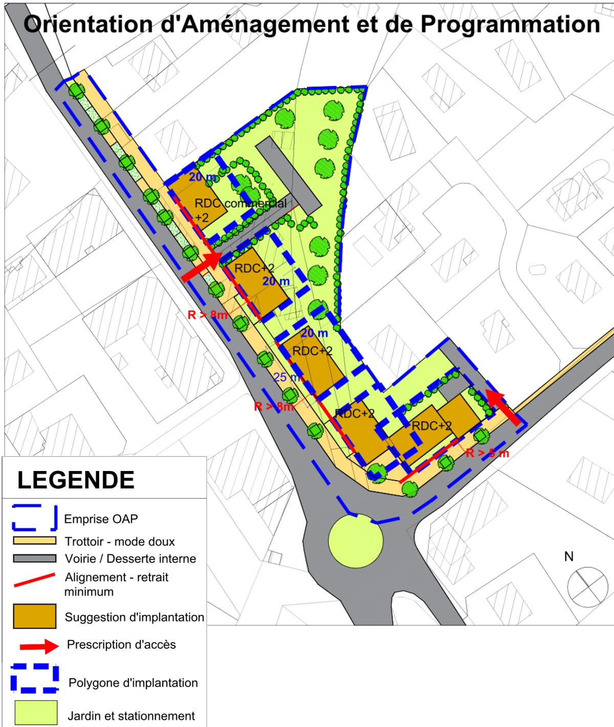
Les polygones définissent des zones d'implantation des constructions futures d'une largeur sur rue de **25 m** et d'une profondeur de **20 m**.
