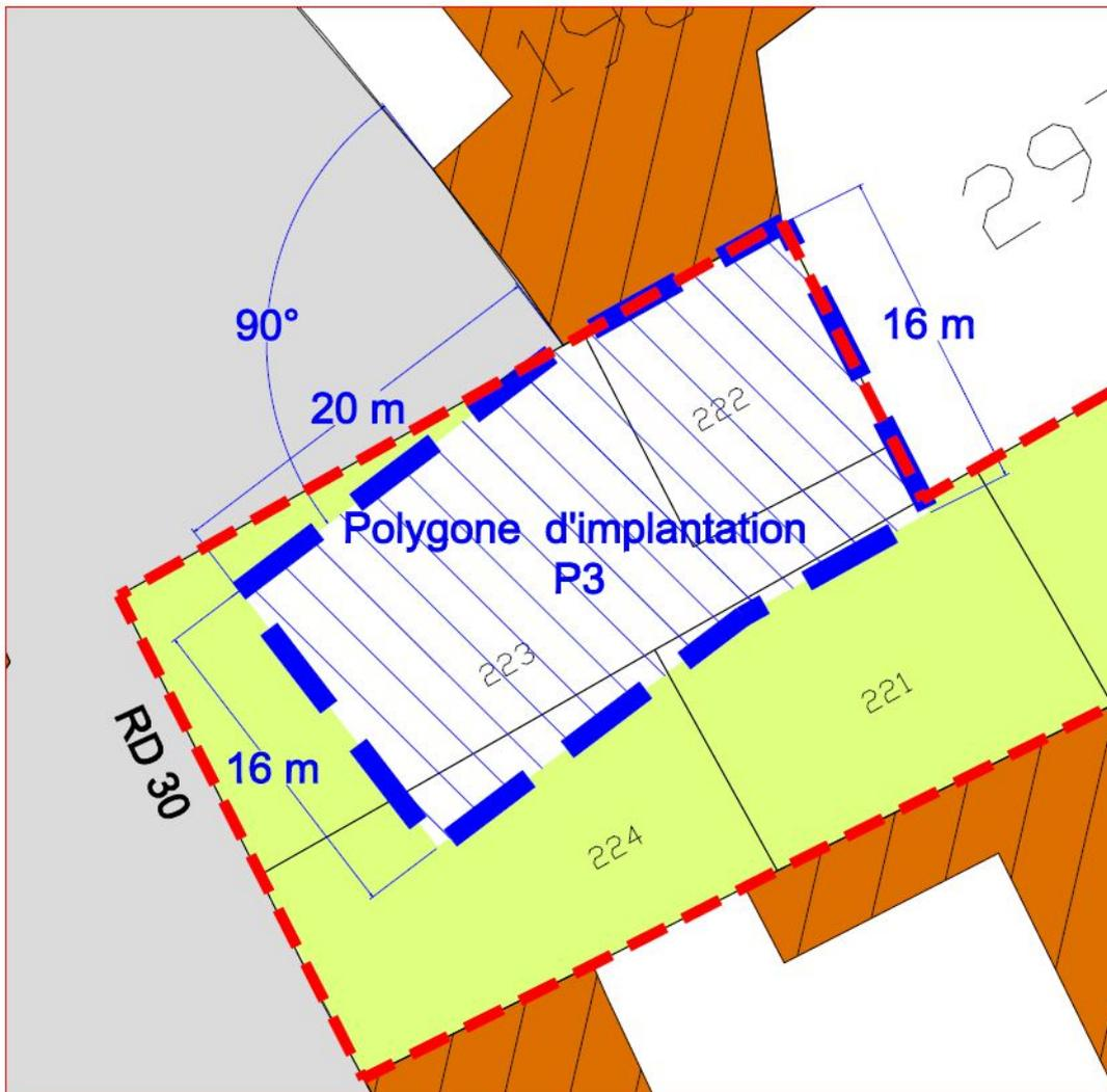
**NB** : Les côtes permettent de positionner le projet pour une emprise totale indicative de **495 m<sup>2</sup>**
